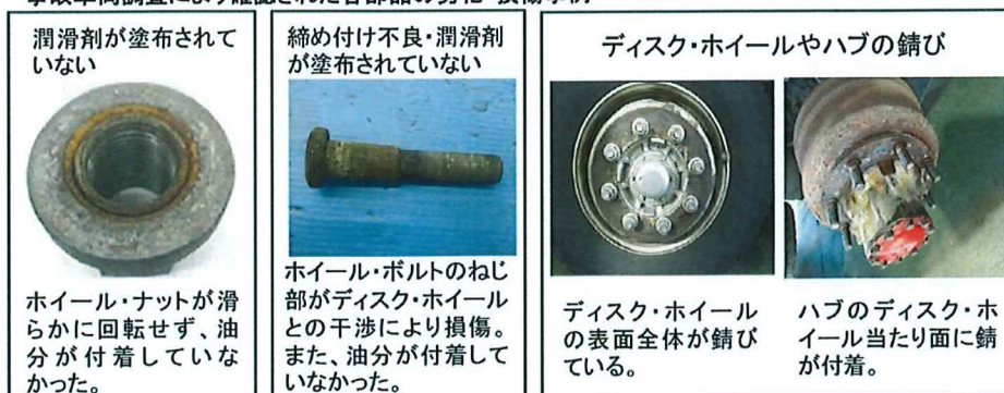
事故車両調査により確認された各部品の劣化・損傷事例
