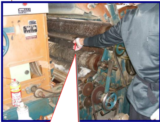
エア吹き付け時の様子を再現。このように右腕をのばして作業していたところ巻き込まれた。
