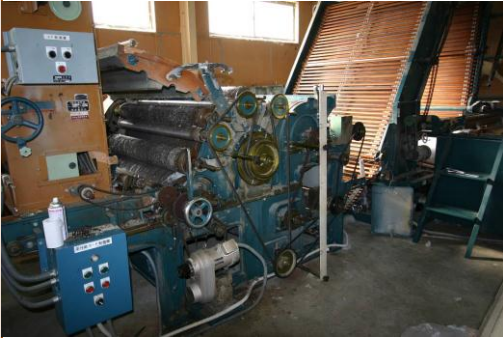
↑綿加工機の全景（災害発生時はカバーを外し、機械を止めずに作業していた。）
