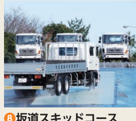
8 坂道スキッドコース (勾配7%・延長200m) 坂道発進、スラローム走行、ブレーキングや回避で横滑りなどした場合の対応を学びます。
